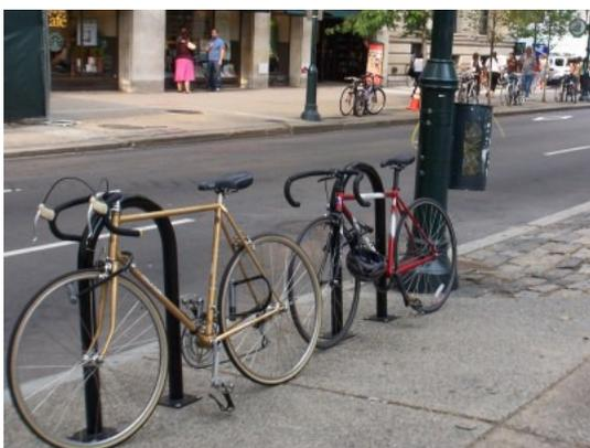
Foto 73 - Exemplo de paraciclo - permite prender a bicicleta pelo quadro
